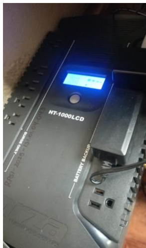
Ilustración 13 7 Acumuladores de energía Forza para protección de corriente de varias estaciones de trabajo
